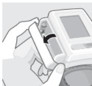
1) Откройте крышку отсека для элементов питания в направлении стрелки, как показано на рисунке.
