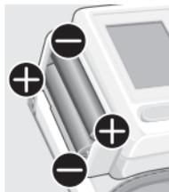
2) Установите два щелочных элемента питания размера "AAA", соблюдая полярность. Элементы питания легко устанавливаются при нажатии концом (-) на пружину.
