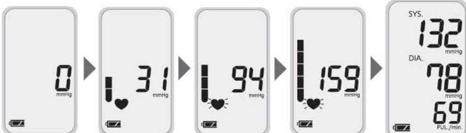
Процесс накачивания манжеты и измерения давления
